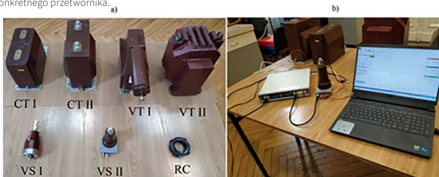
Zdjęcia a) badanych urządzeń, b) stanowiska badawczego do wyznaczania transmitancji przetwornika napięciowego II | The pictures of a) tested devices, b) experimental setup for measuring transfer properties of voltage sensor II
