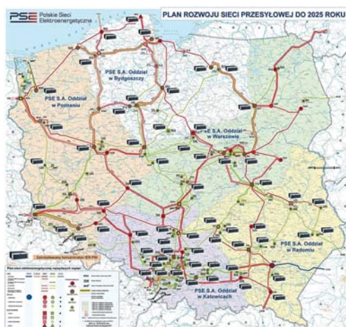
Rys. 1. Graficzne przedstawienie lokalizacji wszystkich typów koncentratorów w stacjach elektroenergetycznych PSE S.A. (opracowane na bazie mapy dostępnej na stronie www.pse.pl) | Fig. 1. Graphic representation of the locations of all types of concentrators in the power stations of PSE S.A. (based on the map available on the website www.pse.pl).
