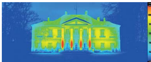
Rozkład luminancji na obiekcie przedstawiony w skali pseudokolor | The luminance distribution of the object presented in False Color scale
