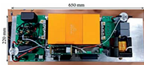
Prototyp izolowanego przekształtnika DC/DC o mocy 20kW opracowany w projekcie REACTION | tłumaczenie
