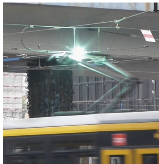
Łuk elektryczny przy prądzie stałym | Electric arc with direct current
