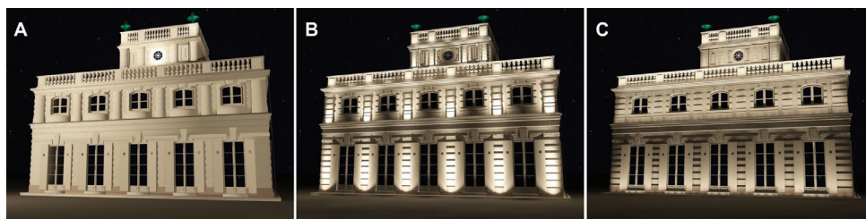
Trzy różne metody iluminacji obserwowane z tego samego kierunku: (a) metoda zalewowa, (b) metoda punktową, (c) metoda warstwową | The three different methods of floodlighting observed from the same viewpoint: (a) the planar method, (b) the accent method, (c) the layered method
