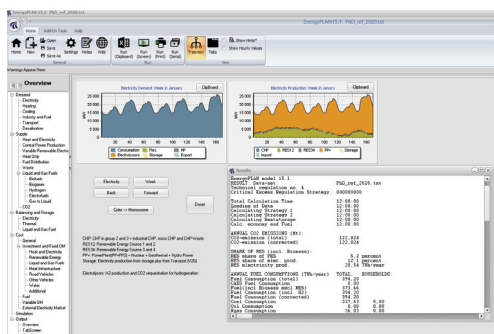
Przykładowe przebiegi symulacji bilansu Krajowego Systemu Elektroenergetycznego w programie EnergyPLAN | Examples of balance simulation of the National Power Grid in the EnergyPLAN
