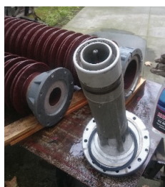
Części układu stykowego i komory gaszeniowej wyłącznika 72.5 kV, model 3D układu stykowego i gaszeniowego | Parts of contact system and extinguishing chamber of 72.5 kV circuit breaker, 3D model
