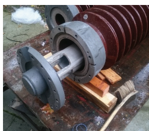
Części układu stykowego i komory gaszeniowej wyłącznika 72.5 kV, model 3D układu stykowego i gaszeniowego | Parts of contact system and extinguishing chamber of 72.5 kV circuit breaker, 3D model
