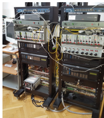
Wygląd testowego systemu telekomunikacyjnego PDH/SDH oraz stanowiska laboratoryjnego do sprawdzania współdziałania urządzeń zabezpieczeniowych | The appearance of the PDH/SDH test telecommunications system and a laboratory stand for checking the interaction of protection devices
