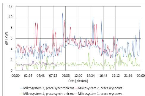
Wyniki optymalizacji w zadaniu minimalizacji strat mocy czynnej | Optimization results in the task of minimization of active power losses
